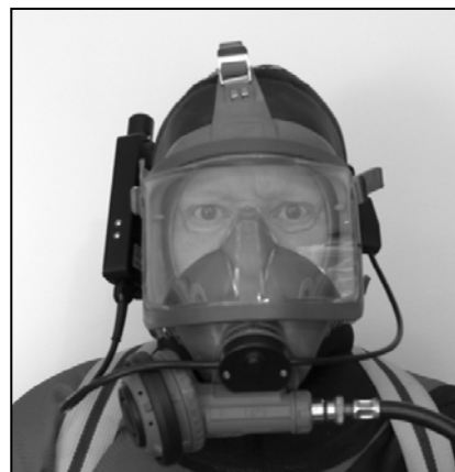
Figur 4, 5: Telefon monterad på helmask.
